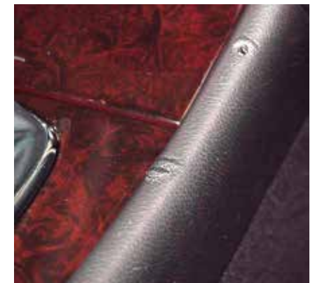
Verformung in der Kunststoffverkleidung
