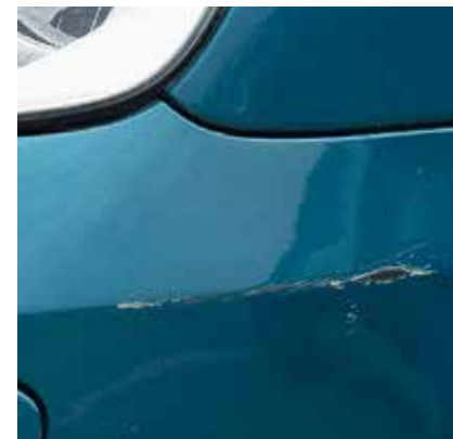
Lackschäden am Stoßfänger
