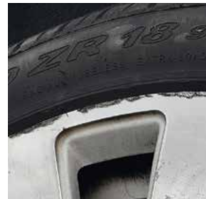
Beschädigung Felgenhorn mit Materialabtragung
