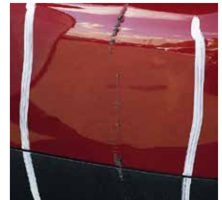
Deformation der Stoßfängerverkleidung
