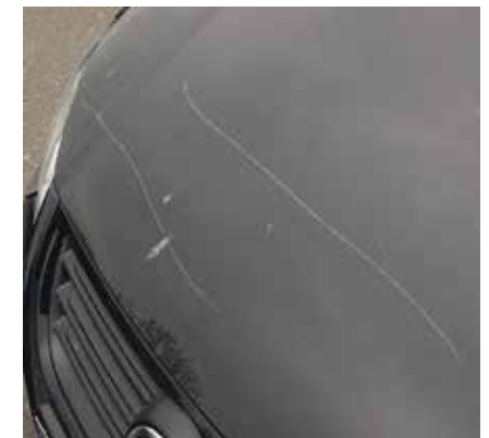
Beschädigung des Basislackes
