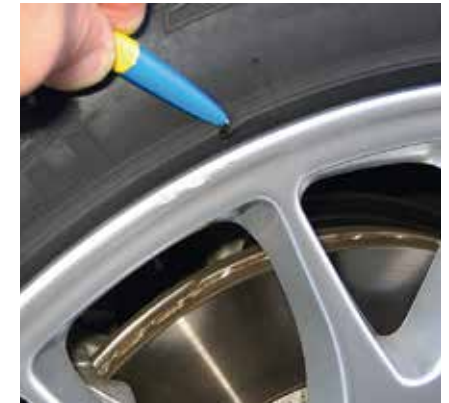
Scheuerleiste leicht eingeschnitten
