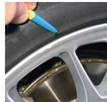
Légère entaille de la bande de protection
