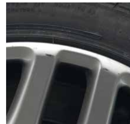
Légères éraflures sans matière manquante
