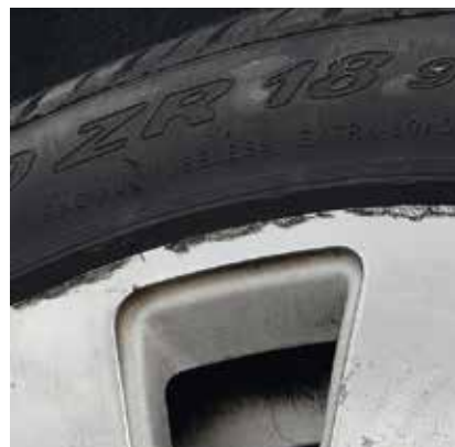
Dommages au rebord de la jante avec matière manquante
