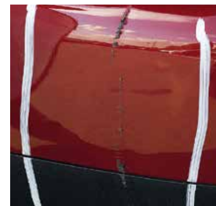
Déformation du revêtement du pare-chocs
