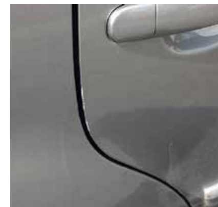
Dégâts mineurs à la peinture
