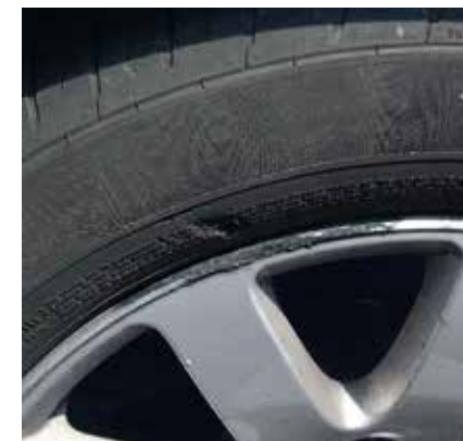
Flanc du pneu endommagé
