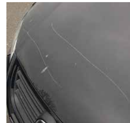
Couche de fond endommagée
