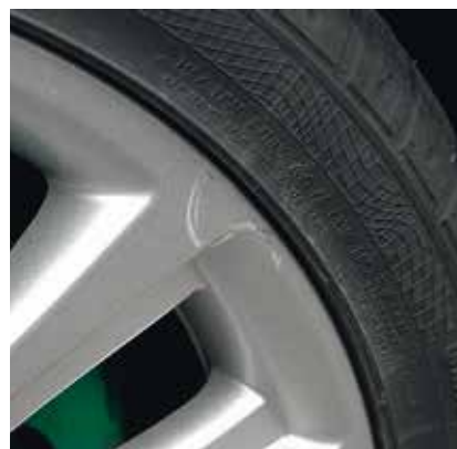
Légères éraflures au rebord de la jante
