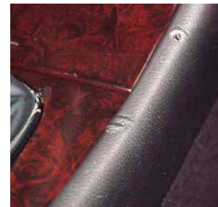
Déformation du revêtement en plastique
